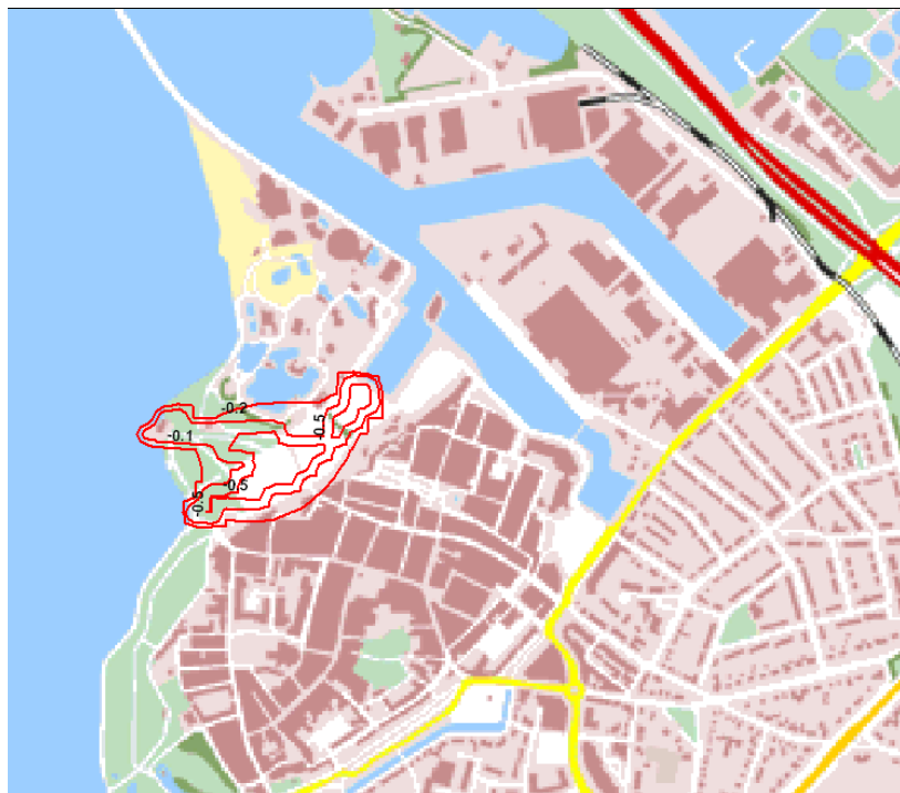
Figuur 2.7 Indicatief berekende verandering GHG ten opzichte van de huidige situatie met peil op +0,25 mNAP peil 0.25 mNAP Veluwerandmeer (referentie 1')
